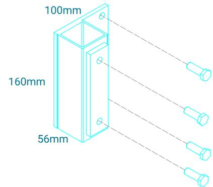
Tornillos de  $\varnothing 10$  con tacos metálicos
