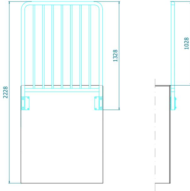
Baranda metálica de acero galvanizado en caliente según UNE-EN ISO 1461.
